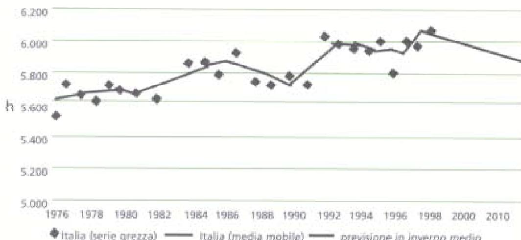
**Fig. 38 - Ore di utilizzazione della potenza alla punta invernale**
